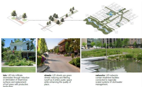
Figura 52 – Interventi d'invarianza idraulica, riferimenti ai manuali LID (2)
