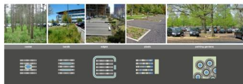
Figura 7. Diversi approcci SuDS per il drenaggio sostenibile della acque di pioggia dai parcheggi. Fonte: Huber, J., 2010. Low Impact Development: a Design Manual for Urban Areas (riadattato)
