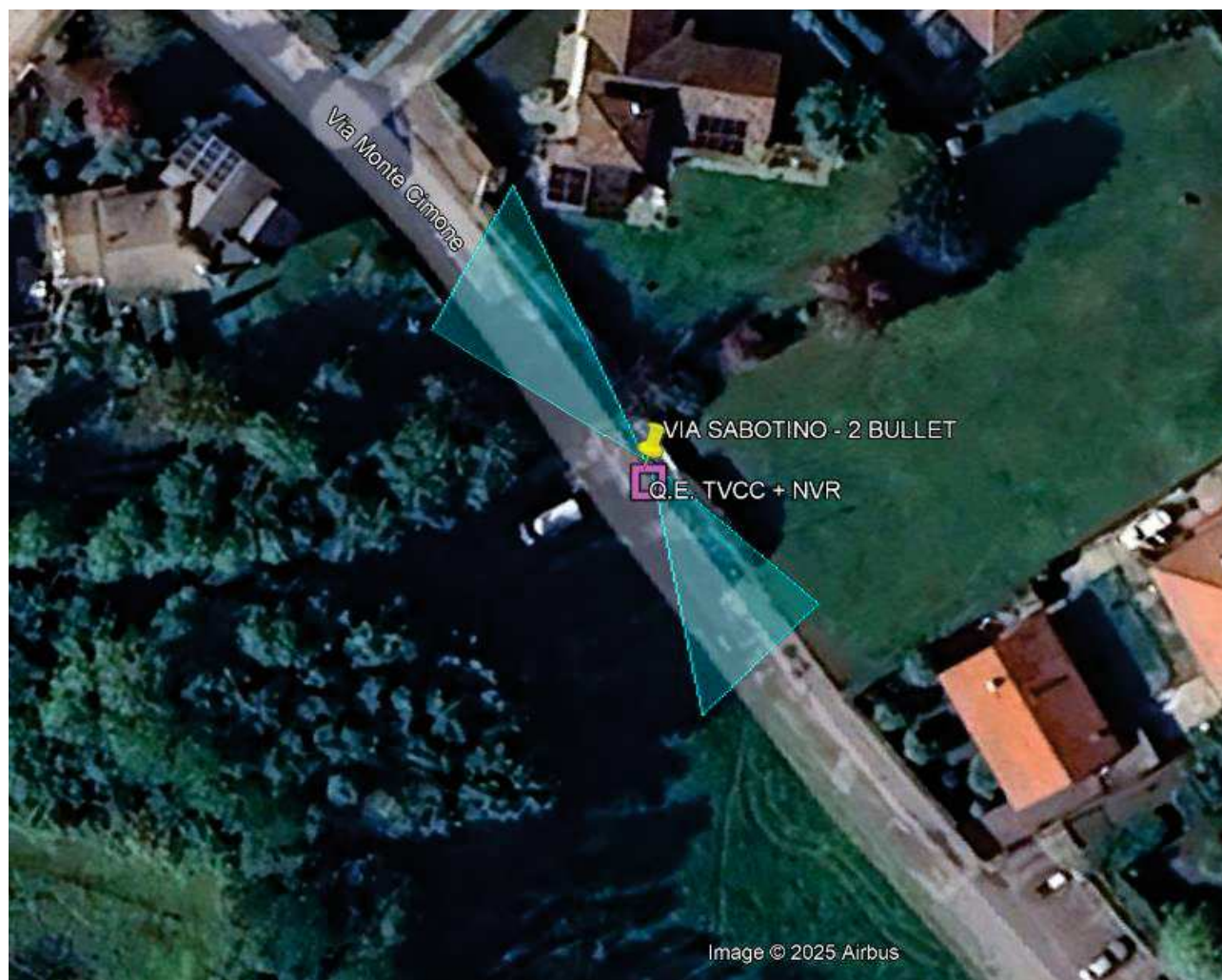
Figura 10 - Punto di installazione delle telecamere
