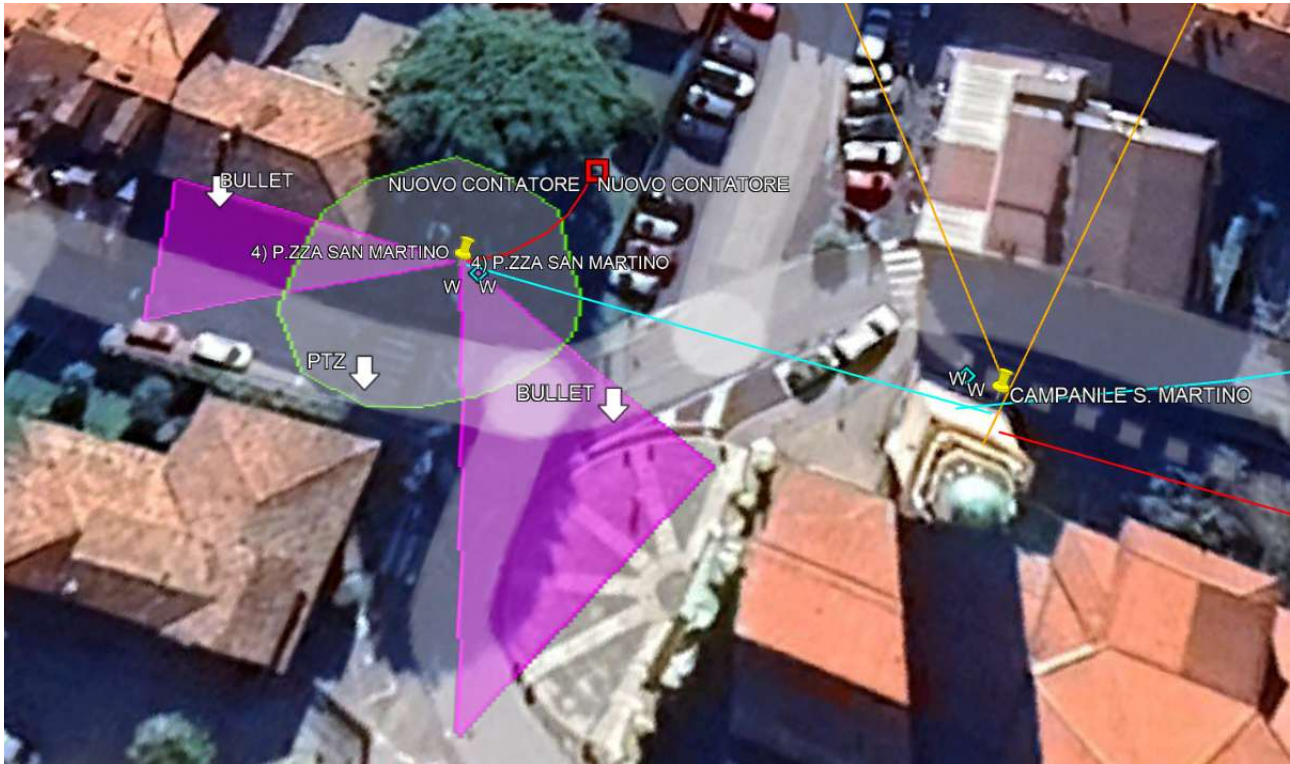
Figura 12 - Punto di installazione delle telecamere
