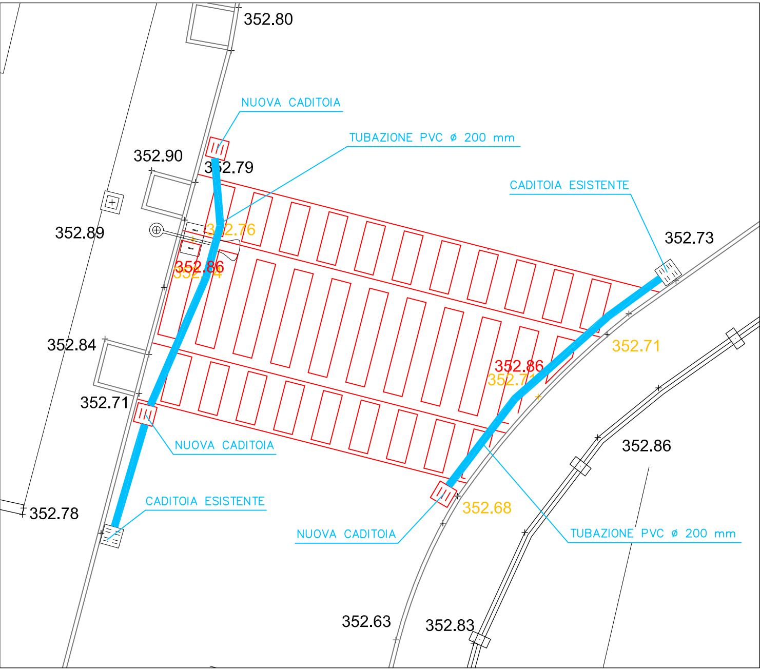
PLANIMETRIA SCHEMA IMPIANTI 1:100
