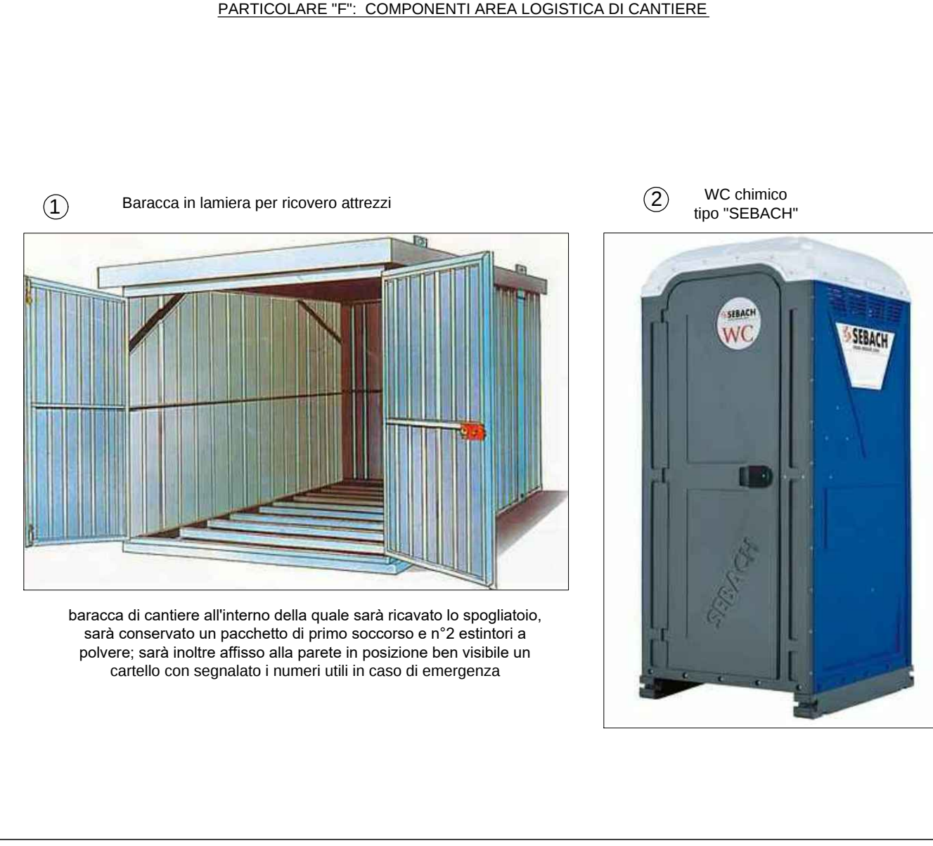
PARTICOLARE "F": COMPONENTI AREA LOGISTICA DI CANTIERE
