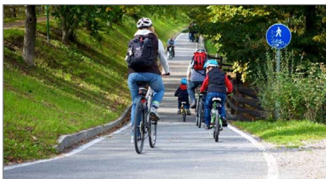
Figura 73: Esempio di pista bidirezionale in sede propria
