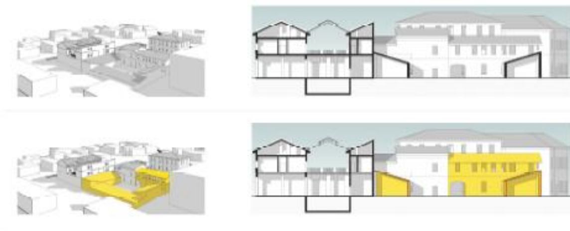
Fig. Lo scenario di riqualificazione generale del comparto degli edifici comunali esistenti individuato dal Progetto di fattibilità 2019. In giallo: gli interventi di demolizione dei vecchi uffici, compresi il magazzino, l'economato e il ricovero dei mezzi comunali previsti e posti in attuazione.
